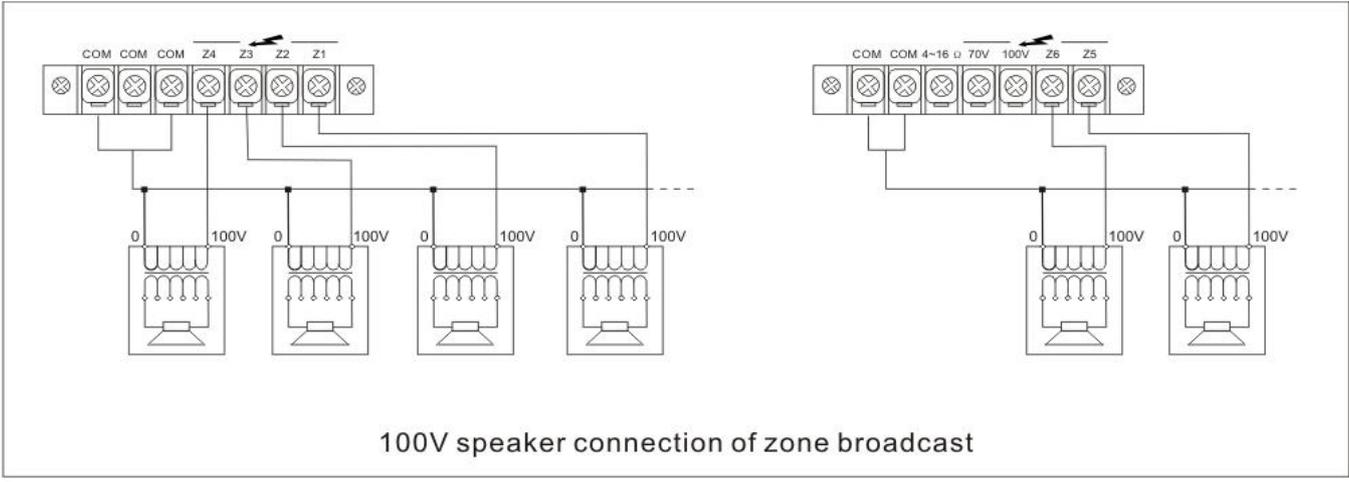
**ATTENZIONE: IL CARICO MASSIMO PER OGNI ZONA E' DI 100W!**
